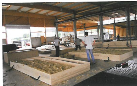
▲ Fabrication des panneaux de façade.
